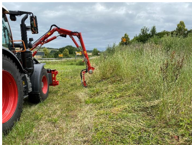
Tierschonender Balkenmäher an Teleskoparm bei Staffelmahd (Foto: K. Ullrich, RLP AgroScience)
